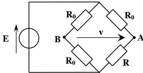
E est une source de tension fixe; v est la tension à en sortie du pont (image de la pression); R<sub>0</sub> sont des résistances ajustables réglées à l'identique;
