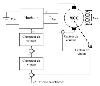
Le moteur est alimenté par une source continue via un hacheur série qui comprend un thyristor GTO et une diode de roue libre D1. Le moteur est soumis à un couple de charge Cr qui peut être variable. L'asservissement de vitesse agit en deux boucles :
