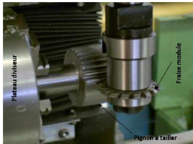
Figure 4.5 : Taillage d'une roue par fraise-module.
