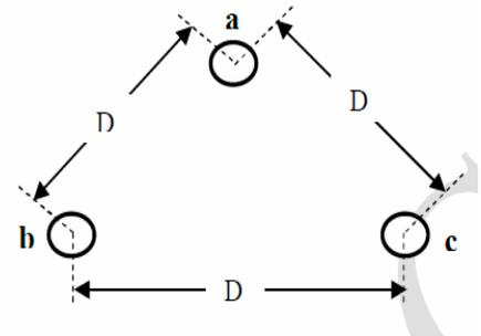
La différence de potentielle  $V_{ab}$  due aux charges des conducteurs a et b peut s'écrire
