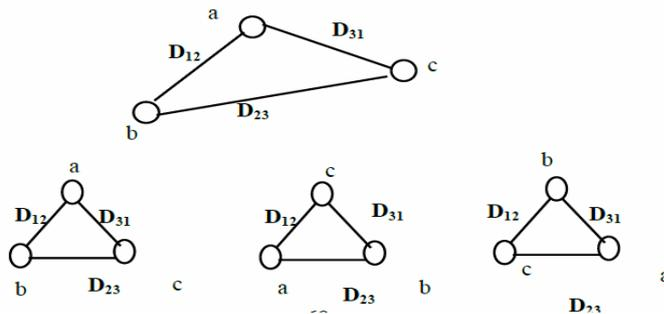
Pendant pour une ligne non transposée, les capacités entre conducteurs et le neutre ne sont pas égales. La capacité moyenne de n'importe quelle phase par rapport au neutre est la même que la capacité moyenne par rapport au neutre de chacune des autres phases, pour une transposition complète de la ligne, Puisque chaque conducteur de phase occupe la même position que les autres conducteurs de phases sur une distance égale le long du cycle de transposition.
