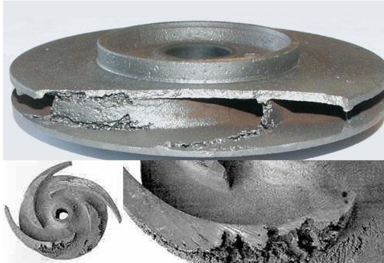
Figure 2.10 : Dégâts par cavitation
