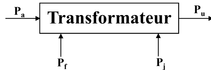
Figure .... Arbre des puissances.
