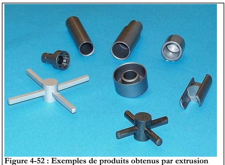
Figure 4-52 : Exemples de produits obtenus par extrusion
