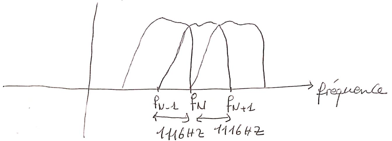
chaque porteuse modulée peut avoir une largeur spectrale allant jusqu'à  $2 \times 1116 \text{ Hz} = 2232 \text{ Hz}$
