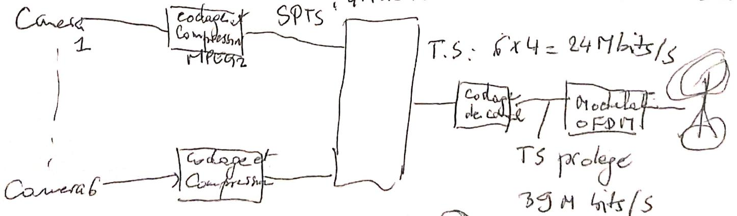
La protection des données met en œuvre 2 techniques complexes de codage de canal.
