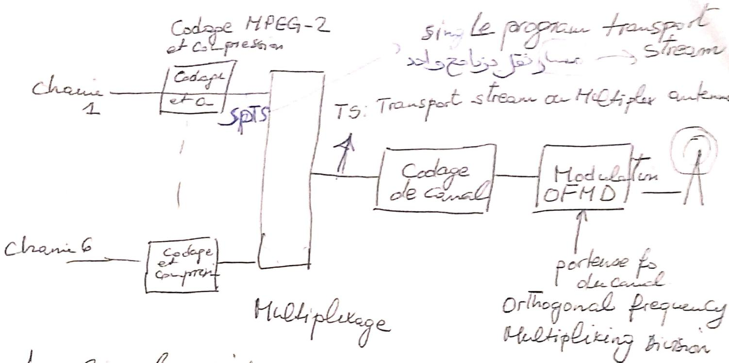
Le signal vidéo + son + données est échantillonné et compressé en MPEG 2, mélangé à 5 autres signaux, protégé contre les erreurs de transmissions puis module la porteuse.
