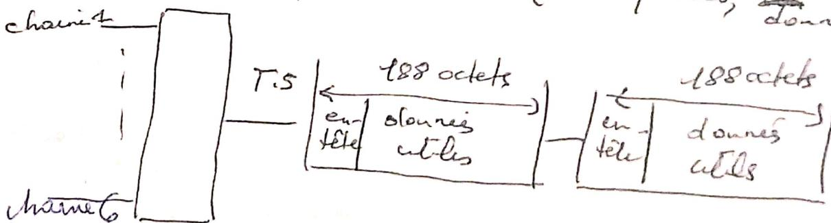
Grâce aux en-tête le récepteur pourra réparer les données correspondant aux 4 chaînes du multiplex.
