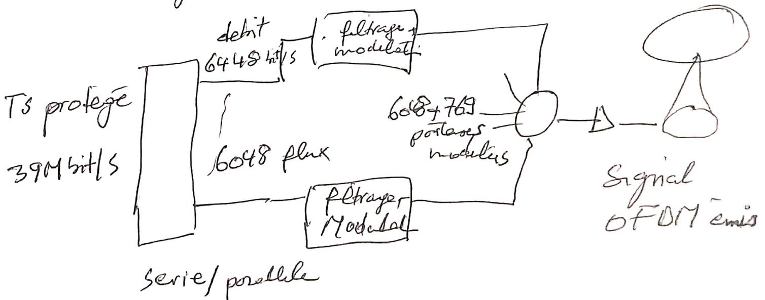
Le récepteur peut démoduler ces 6817 porteuses, même si elles se recouvrent partiellement
