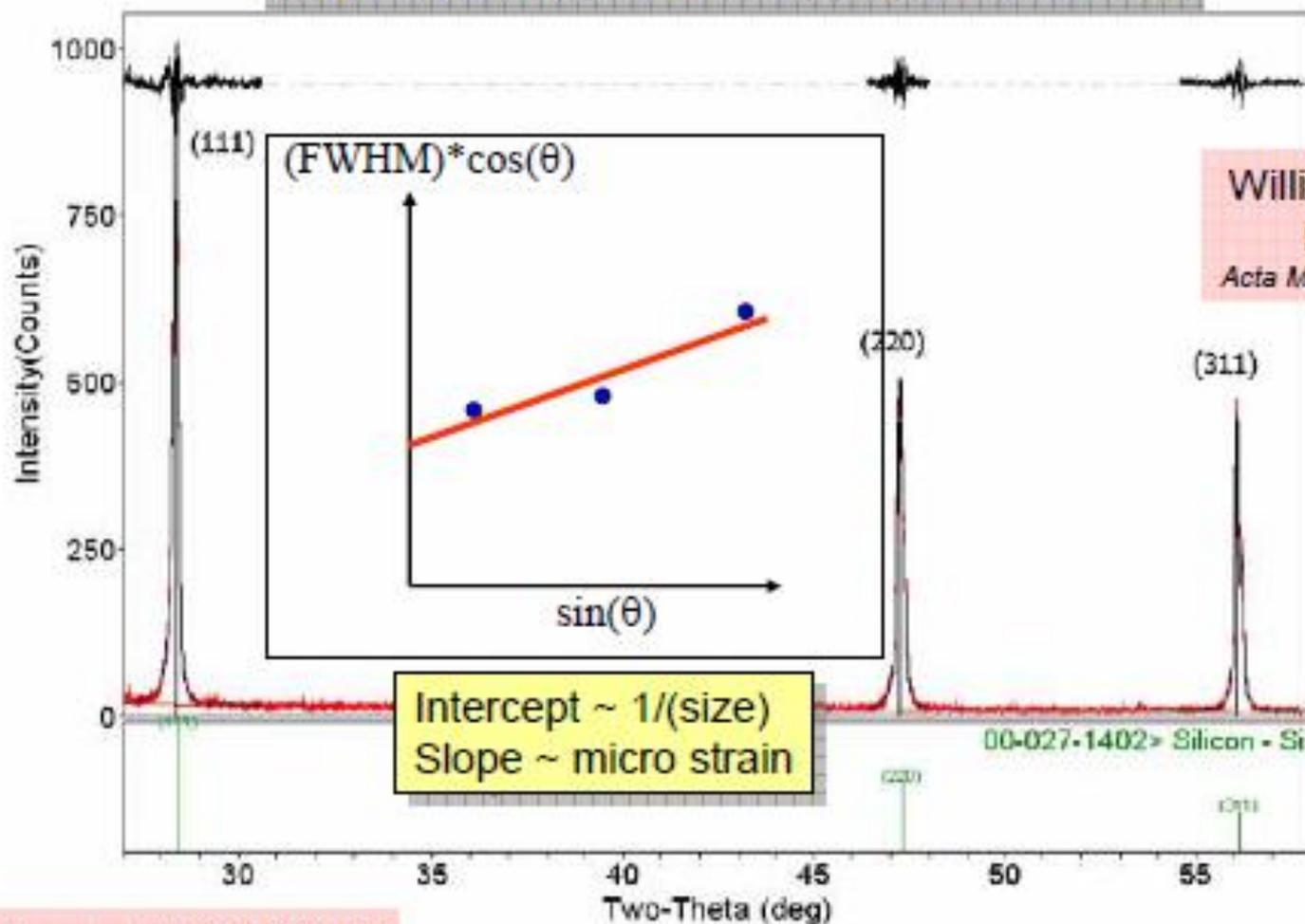
$$\text{FWHM}_{\text{strain}} = 4 \cdot (\text{strain}) \cdot \tan \theta$$
