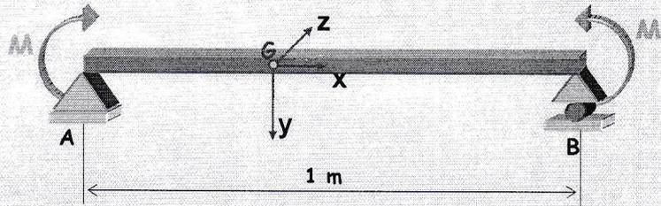
Le système est autoéquilibré, les réactions en A et B sont nulles. Dans la section G le Torseur de Section se réduit à une seule composante du moment suivant l'axe z :  $M_z = -M$ . Toutes les sections G sont donc équidangereuses. Nous sommes donc en présence de Flexion Pure.
