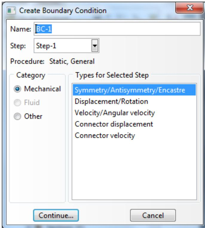
Sélectionner l'arrête de la pièce on met l'encastrement et valider par **Done**.
