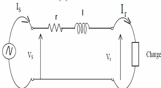
La relation entre la tension et le courant de départ  $V_s, I_s$  et la tension et courant d'arrivée
