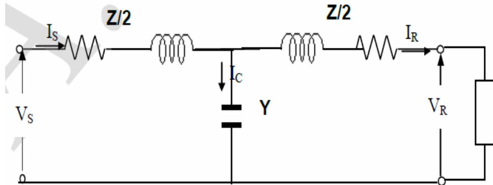
Puisque La tension  $V_C = V_R + I_R \cdot Z/2$  et le courant  $I_C = V_C \cdot Y$
