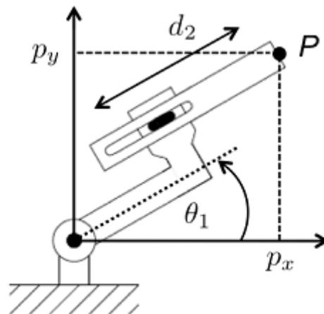
Figure 2 : Robot planaire à 2 DDL (RP).
