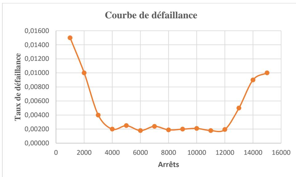
On constate que la génératrice commence à se dégrader à partir de 12000 heures de fonctionnement. Le comportement en baignoire du taux de défaillance est signe d'un fonctionnement plus au moins normal.
