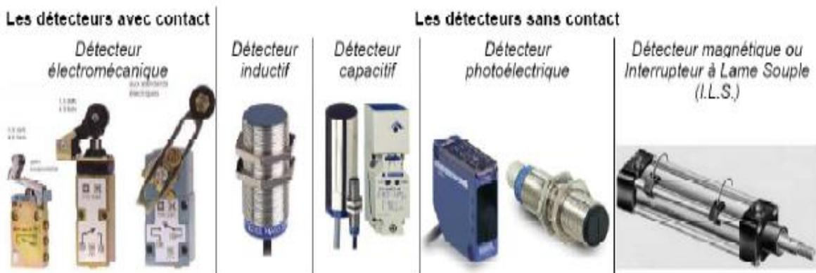
**a) Les détecteurs inductifs** : sont sensibles aux matériaux conducteurs. Lorsqu'on approche une pièce métallique du détecteur, le champ magnétique est modifié. Au delà d'un certain seuil, l'objet est détecté.
