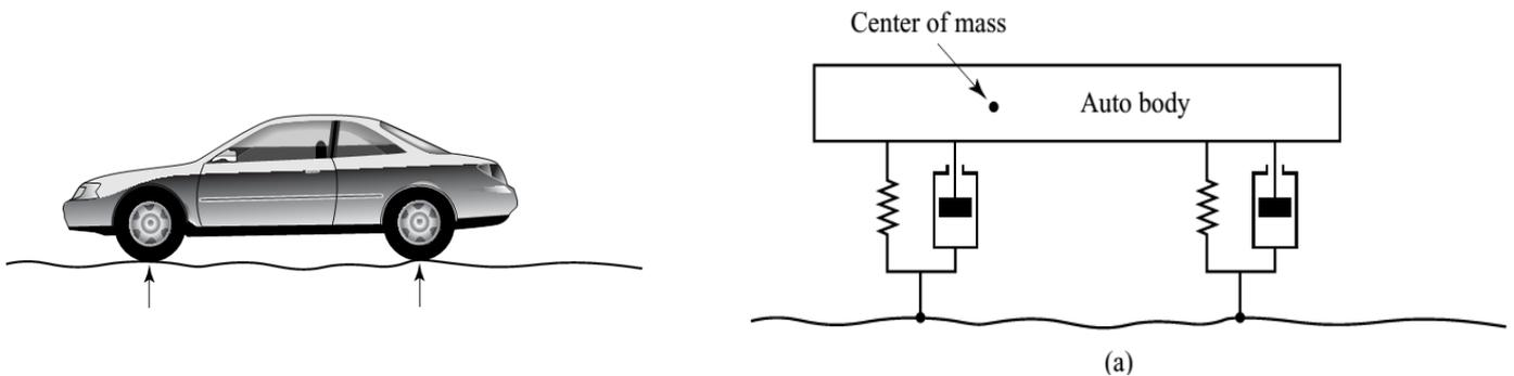
Une version très simplifiée du système de suspension est représentée sur la figure ci-contre. En supposant que  $f(t)$  est l'entrée du système et que le mouvement vertical  $y(t)$  du corps est la sortie,
