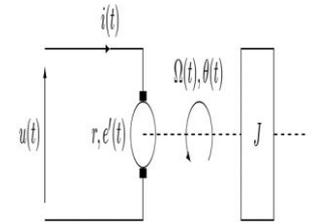
• **Objectif:** Déterminer la fonction de transfert liant l'entrée  $u(t)$  et la sortie  $\Omega(t)$ .
