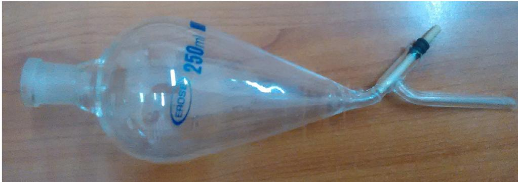
Fig.7. Ampoule à décanter
