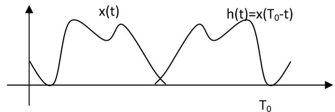
Cette réponse n'est pas causale ce qui ne permet pas de l'appliquer en temps réel. Cependant, ce filtre peut-être appliqué à un signal sauvegardé.
