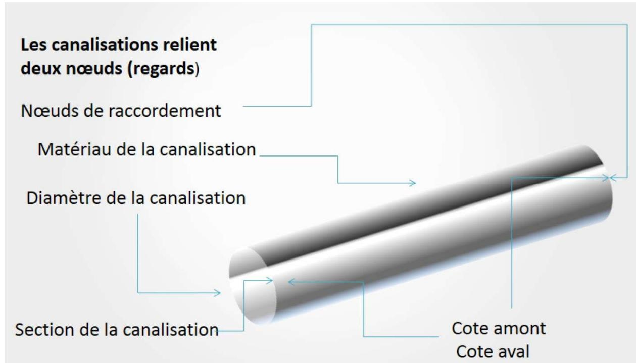
Le diamètre des buses en béton armé pour réseaux assainissements en Algérie ont des diamètres **300-400-500-600-800-1000-1200-1500-2000**, disponibilité avec ou sans ancrs/avec ou sans joints.
