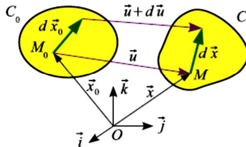
**Figure .III.3.** Transformation d'un point et d'un vecteur
