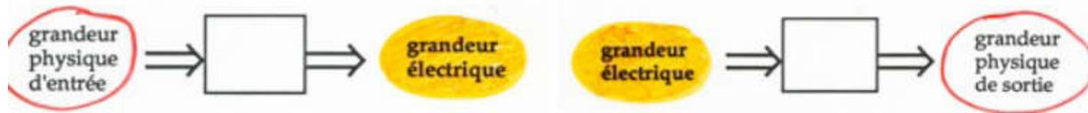
• **Capteurs, senseurs ou détecteurs**: fournissent comme signal de sortie 1 quantité électrique utilisable en réponse à une grandeur, une propriété ou une condition physique à mesurer.
