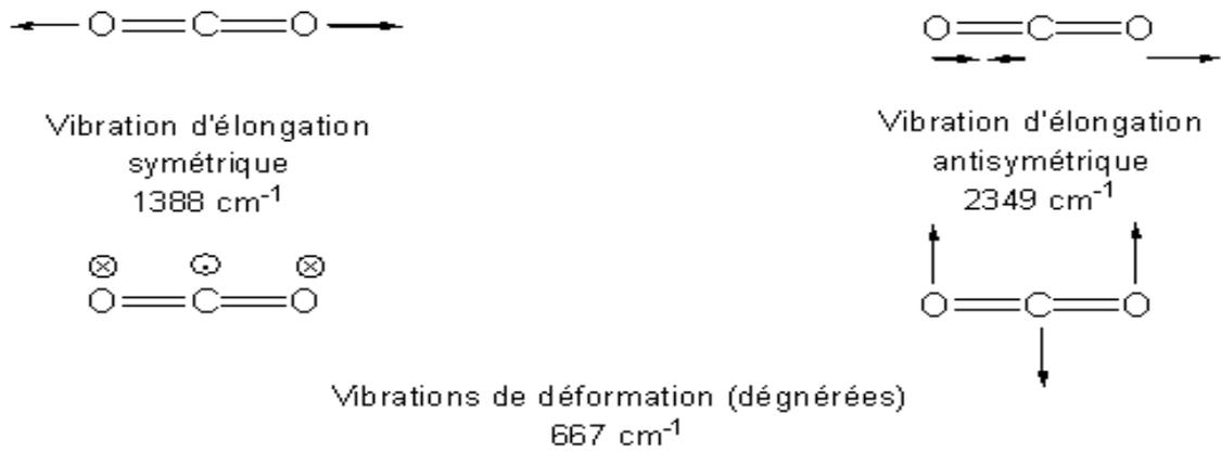
**Les quatre modes propres de vibration du dioxyde de carbone.**
