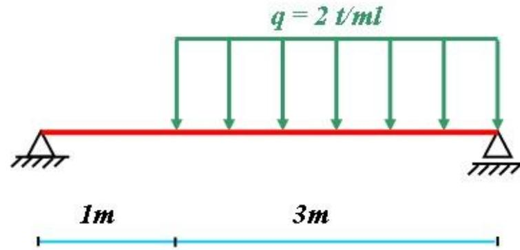
**Solution:** Pour trouver la flèche au milieu de la poutre, on applique une force unitaire dans ce point. L'état (a) est l'exercice en lui-même, l'état (b) est celle de l'application de la force unitaire.
