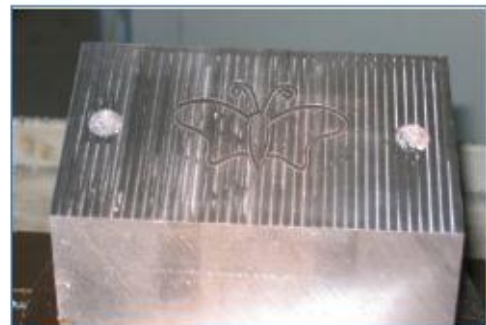
Figure I. 44– Résultat de l'usinage du profil papillon. [61]
