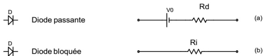
Figure III.11. Schéma équivalent à une diode. (a) cas d'une diode passante, (b) cas d'une diode bloquée.
