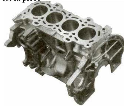
Dans le moteur, le carter-cylindres supporte la pompe à huile, la pompe à eau, l'alternateur, souvent le démarreur et le filtre à huile.
