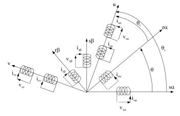
$$\left[x_{r\alpha\beta}\right] = P(\theta_r) \left[x_{rdq}\right] \text{ avec}$$
