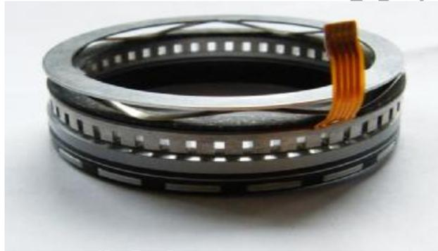
Moteur piézoélectrique de l'autofocus d'un appareil photographique
