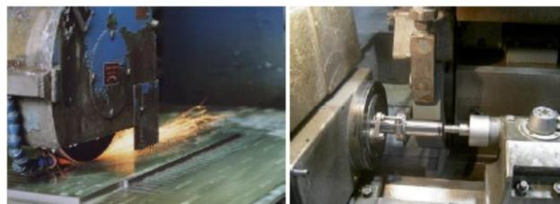
Figure II.6. Rectification plane et cylindrique, [4,5]
