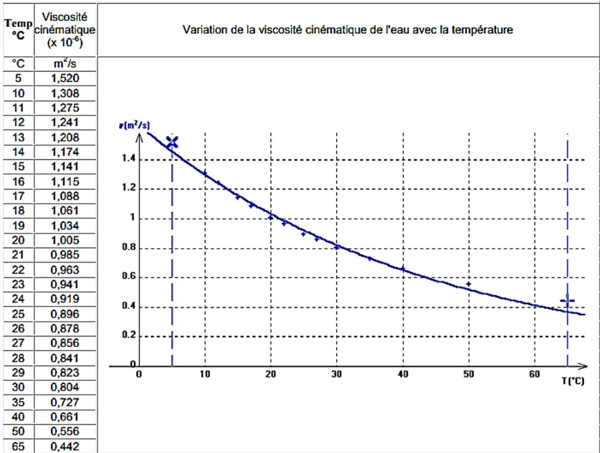
Fig. 3.5- Variation de la viscosité cinématique de l'eau avec la température
