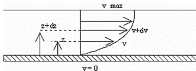
Fig. 3.4- Courbe de vitesse au plan fixe
