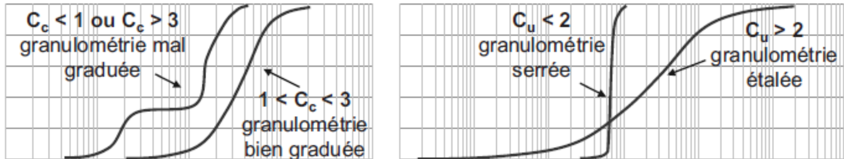
FIGURE 1.3 Interprétation des coefficients C_u et C_c
