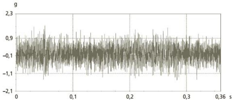
**Figure.2.7.** Signal temporel « brut » délivré par un accéléromètre fixé sur un des paliers MV d'un réducteur
