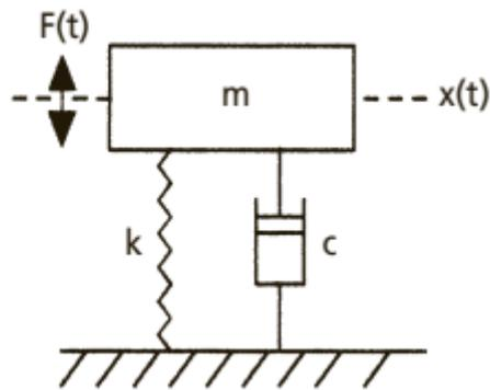
**Figure 2.5.** Système masse ressort à un degré de liberté
