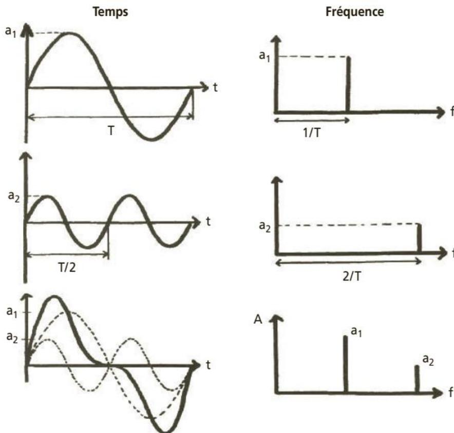
**Figure 2.10.** Exemples de conversion temps/fréquences d'un signal temporel
