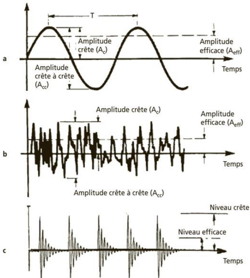
**Figure 2.2.** Représentation des différentes amplitudes caractéristiques dans le cas d'un signal sinusoïdal (en a), complexe (en b), impulsionnel périodique (en c)
