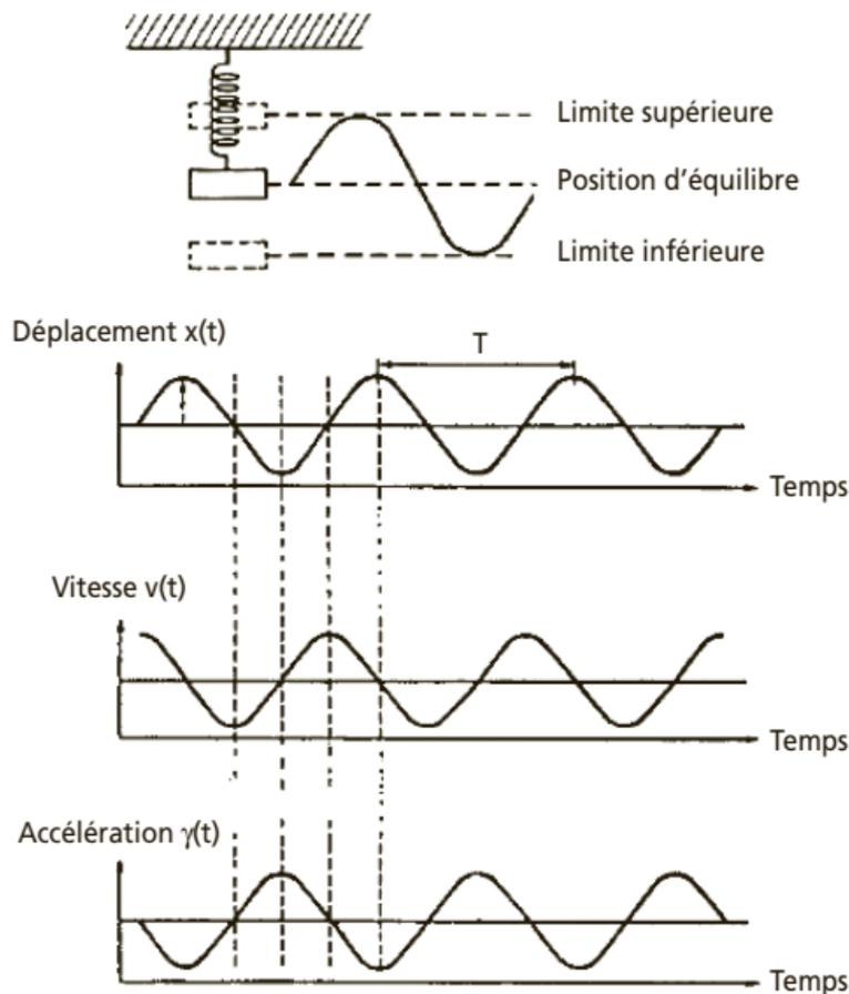
**Figure 2.3.** Représentations du mouvement d'un système masse-ressort
