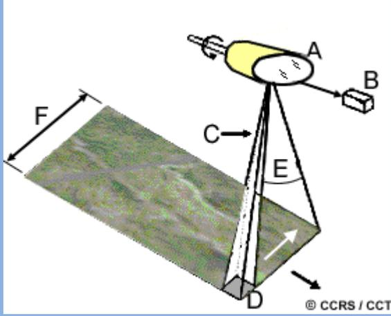
ويحدد كل من المجال اللحظي للرؤية (نطاق الرؤية) للمستشعر (C) وارتفاع التصوير درجة الوضوح الأرض للخلية المصورة (D) Ground Resolution Cell وبالتالي تحدد درجة الوضوح المكاني. ويعتبر في هذه الحالة المجال الزاوي للرؤية (E) Angular Field of View هو النطاق الذي تتحرك من المرآة sweep of the mirror ، ويقاس بالدرجات التي تستخدم لتسجيل خط المسح scan line وتحدد اتساع الرقعة المصورة (F)
