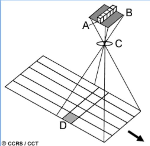
ويستخدم أيضاً الحركة الأمامية لحامل المستشعر (طائرة / قمر صناعي) بهدف تسجيل خطوط المسح الضوئي بطريقة متتابعة وتكوين مرئية ثنائية البعد ملتقطة عمودياً على اتجاه الطيران. لكن بدلاً من المرآة يستخدم هذا النوع من الماسح الضوئي نسق خطي من المتتبعات Linear array of detectors (A) مثبتة عند المحور البؤري للمرئية (B) والمؤلف من أنظمة عدسات (C) يتم "دفعها" في اتجاه حركة الطيران. ويسمى هذا النظام أيضاً باسم
