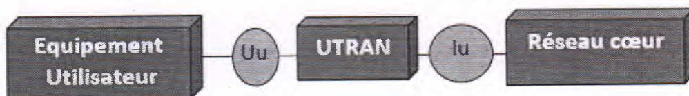
Figure 1-12 : Schéma bloc d'un modèle d'architecture du réseau UMTS
