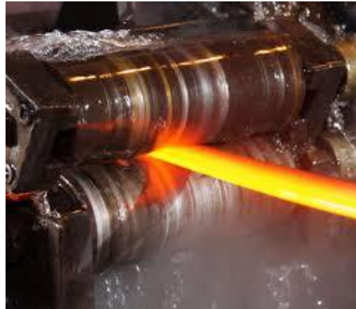
Figure 3. Laminoir simple et laminage à chaud
