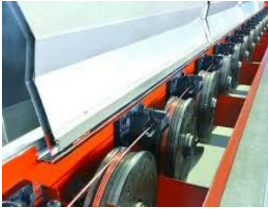
Figure 4. Tréfileuse et filière de tréfilage en carbure de tungstène
