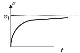
**02** : Quelle est la vitesse limite d'une bille sphérique en chute dans de l'huile de viscosité " $\eta$ ".
