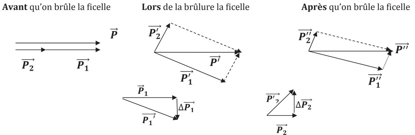
Puisque le système est isolé, la quantité de mouvement est conservée  $\vec{P} = \vec{P}' = \vec{P}''$ , mais pour les disques constituants ce système sont en interaction, ce qui change leurs quantités de mouvement  $\vec{P}_1$  et  $\vec{P}_2$ .
