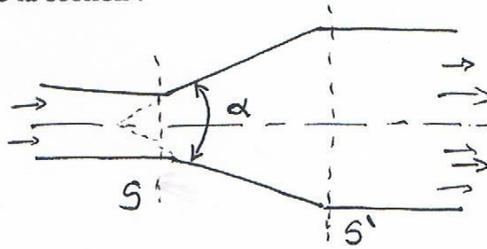
3/ Entrée ou sortie des tuyauteries ( élargissement brusque- rétrécissement brusque) :
