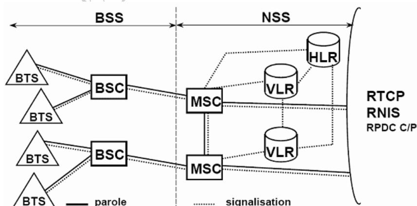
La mise en place d'un réseau GSM (en mode circuit) va permettre à un opérateur de proposer des services de type « Voix » à ses clients en donnant accès à la mobilité tout en conservant un interfaçage avec le réseau fixe RTC existant.
