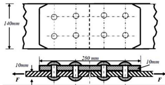
1- Pour vérifier la résistance du système, on doit vérifier la résistance de chacune des deux tôles au niveau de la section dangereuse qui passe naturellement par les axes des rivets, comme montrée ci-dessous, avec  $b = 14 \text{ mm}$ ,  $t = 10 \text{ mm}$ ,  $d = 20 \text{ mm}$ .
