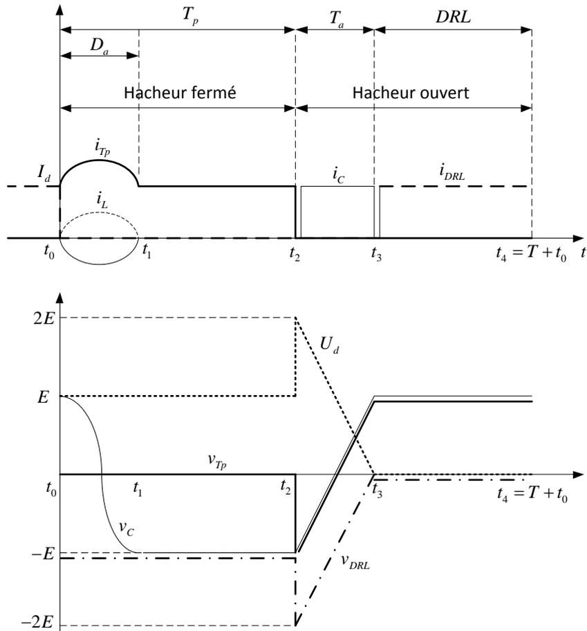
Le circuit de blocage en tension impose à la charge et la DRL une surtension importante.
