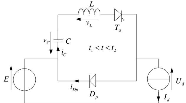
Le courant dans la diode  $D_p$  s'annule à l'instant  $t_2$  défini par :  $i_{Dp}(t_2) = 0$ , ce qui en découle :
