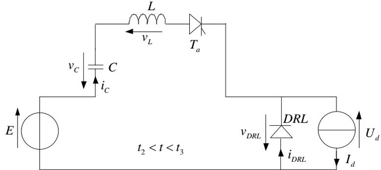
$$\text{Avec } v_c(t_2) = E \text{ et } \frac{dv_c(t_2)}{dt} = \frac{I_d}{C}$$
