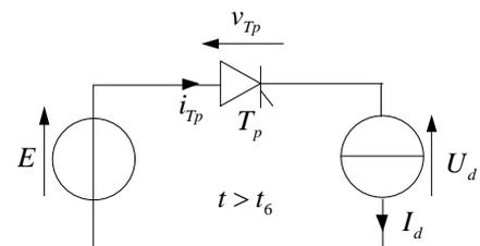
Cette phase est identique à celle décrite pour  $t < t_0$ . Par identification, on peut en déduire la valeur de  $v_0$ . En effet :
