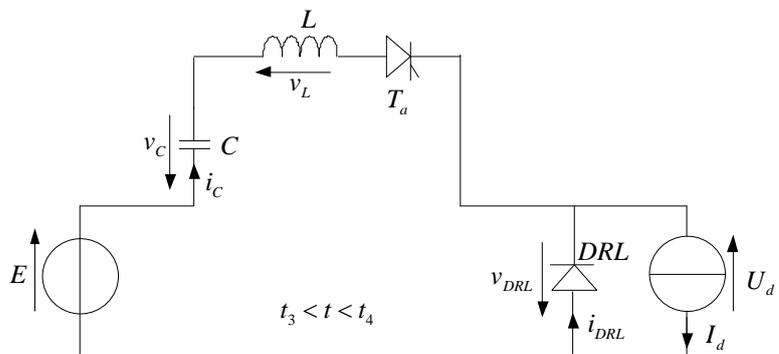
$$v_C(t) = E + A \cos(\omega(t - t_3)) + B \sin(\omega(t - t_3)); \text{ avec } \omega = \frac{1}{\sqrt{LC}}$$
