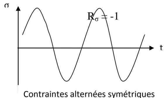
Pour chaque niveau de contrainte  $\sigma_{\max}$ , on détermine le nombre N de cycles à rupture. Ce dernier est utilisé pour prévoir la **durée de vie** d'une pièce en service en fonction de ses sollicitations.
