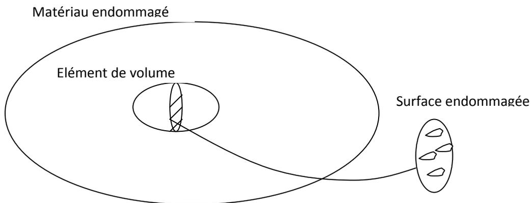
Pour un endommagement isotrope, on mesure l'endommagement local par la variable d'endommagement notée  $D$ :
