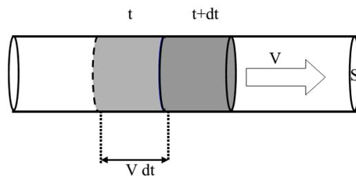
**Figure 3.4** : Flux de puissance
