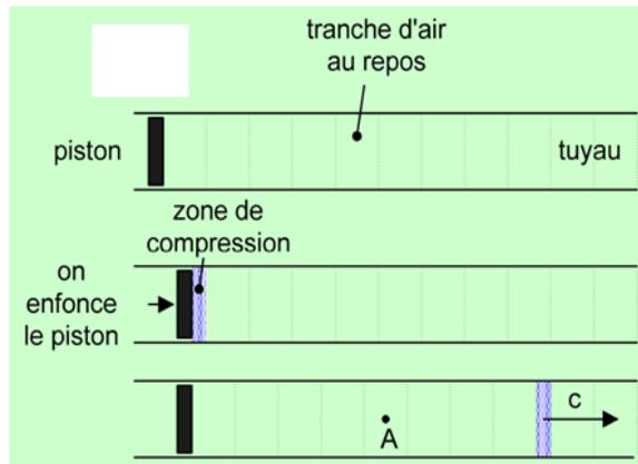
Figure 3.1 propagation onde acoustique dans fluide
