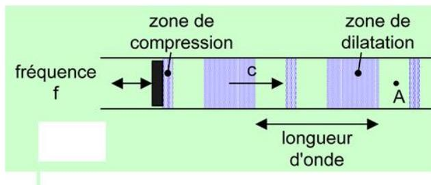
Figure 3.2 Propagation d'une onde sonore plane sinusoïdale
