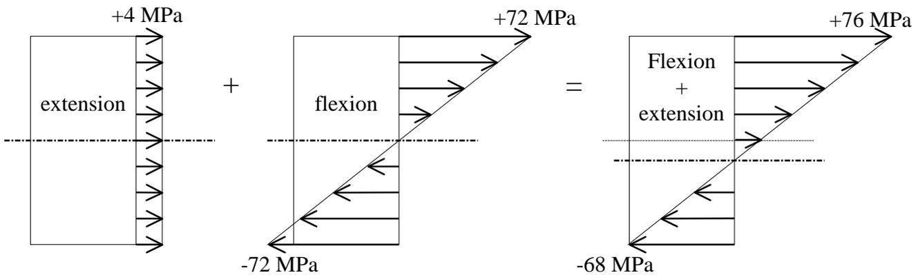
On observe dans la superposition un décalage de la fibre neutre.
