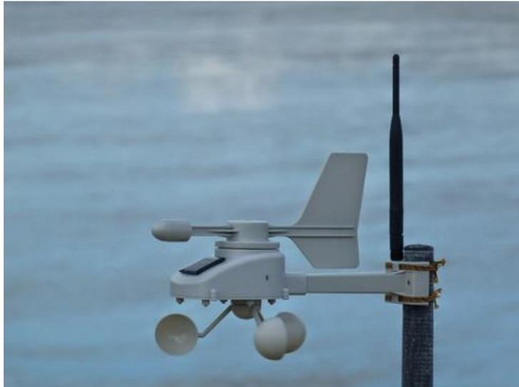
Anémomètre et girouette pour mesurer la direction et la vitesse du vent.
