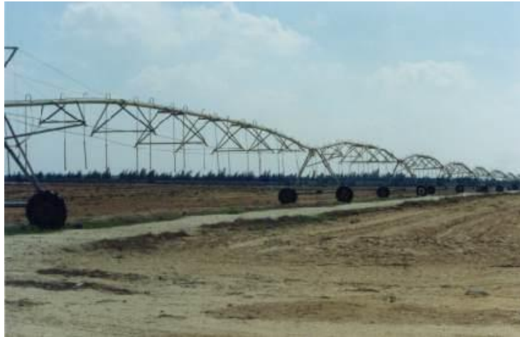
Le système d'aspersion par pivot central
