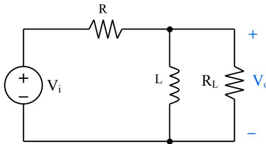
FIG. 3.6 – Filtre passe-haut RL série avec charge
