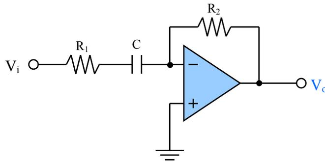
FIG. 3.7 – Filtre passe-haut avec ampli-op
