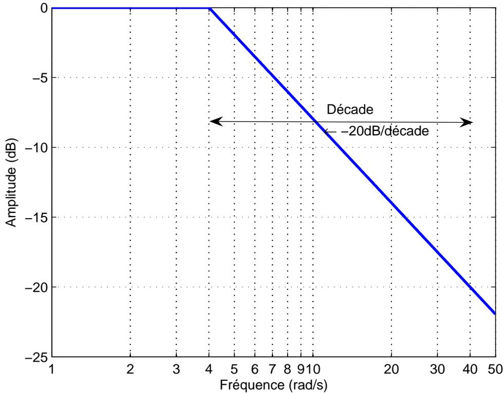
FIG. 3.15 – Exemple de diagramme de Bode pour  $p_1 = 4$
