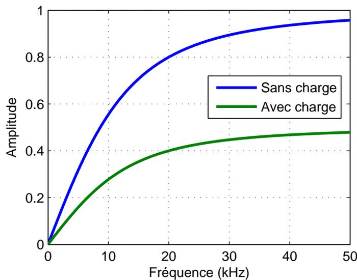
On voit bien que l'amplitude du circuit avec charge est plus faible, et que sa fréquence de coupure est plus faible aussi. Puisque le rapport  $R_L/(R + R_L) = 1/2$ , l'amplitude maximale du filtre avec charge est la moitié de l'amplitude sans charge, et sa fréquence de coupure est la moitié aussi.
