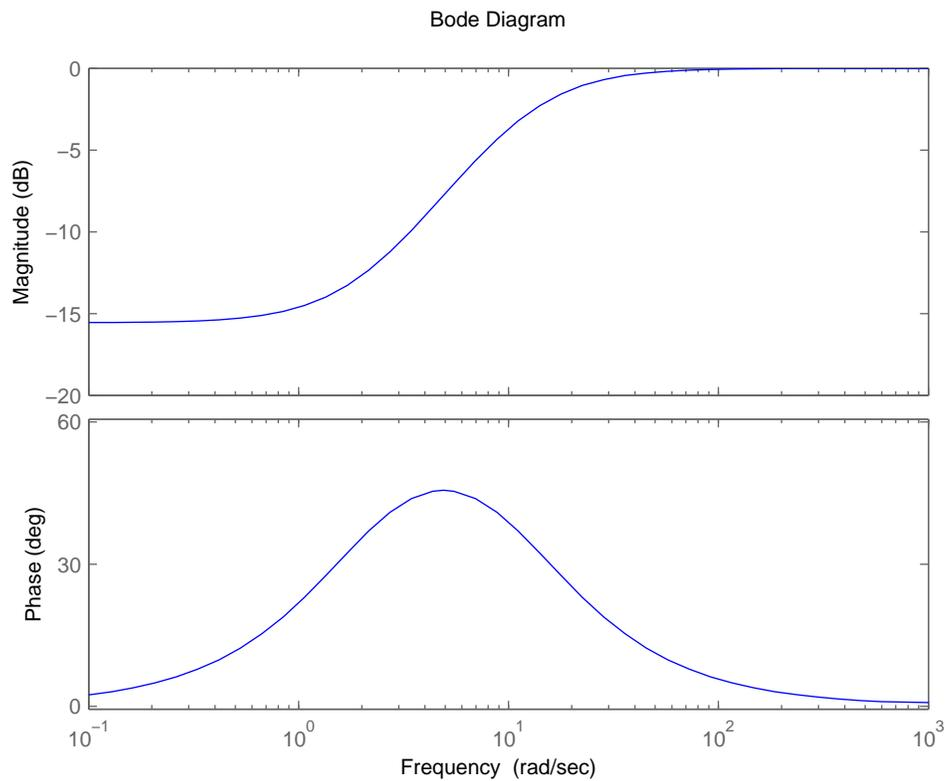
FIG. 3.17 – Exemple de diagramme de Bode (amplitude et phase) avec Matlab
