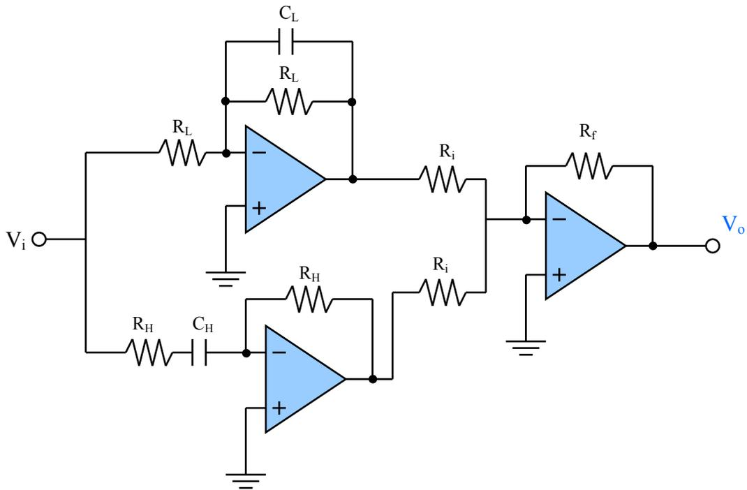
FIG. 3.13 – Filtre à élimination de bande actif
