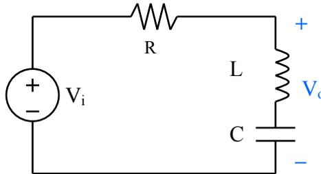
FIG. 3.11 – Filtre à élimination de bande RLC série
