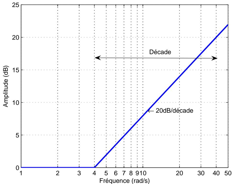
FIG. 3.14 – Exemple de diagramme de Bode pour  $z_1 = 4$
