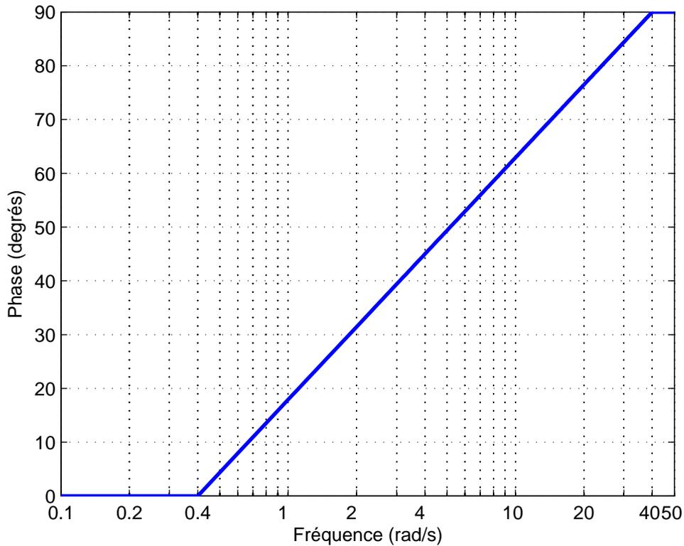
FIG. 3.16 – Exemple de diagramme de Bode (phase) pour  $z_1 = 4$
