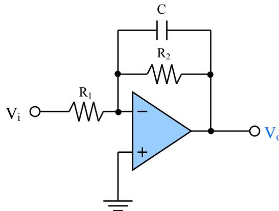
FIG. 3.4 – Filtre passe-bas avec ampli-op
