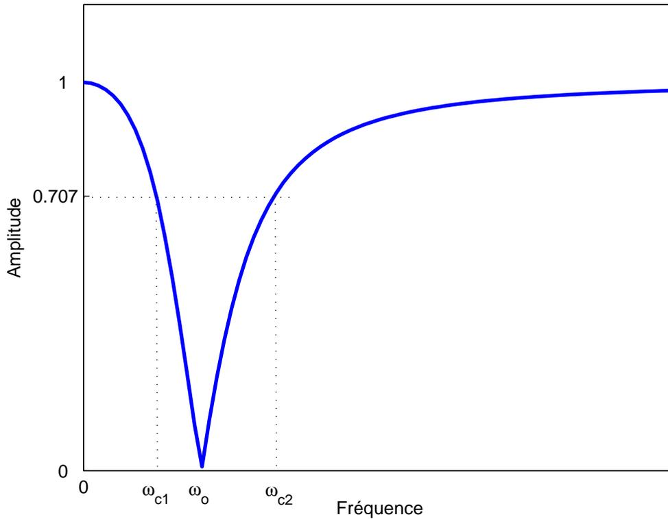
FIG. 3.12 – Réponse typique d'un filtre à élimination de bande RLC série
