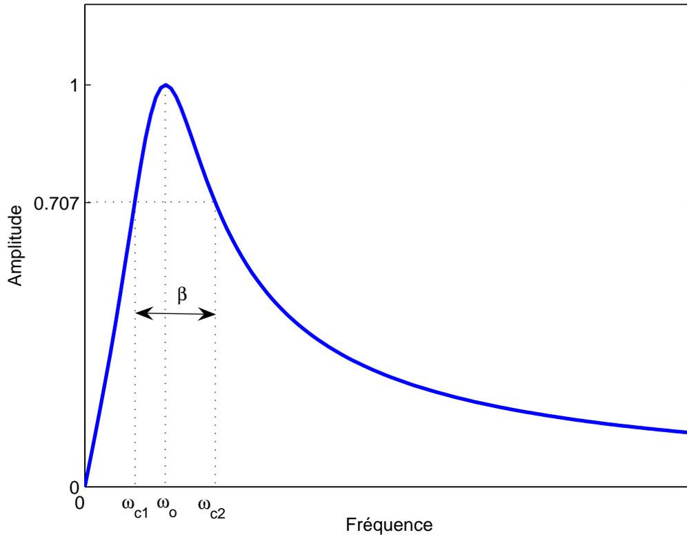
FIG. 3.9 – Réponse en fréquence d'un filtre passe-bande RLC série
