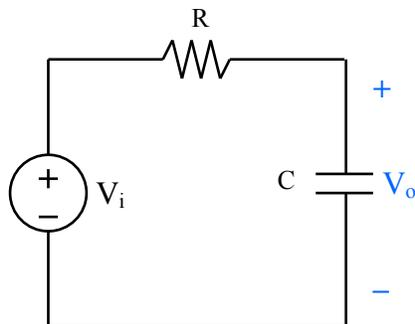
FIG. 3.3 – Filtre passe-bas (RC série)
