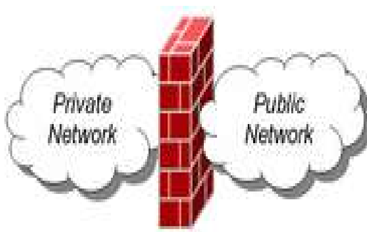
Structure simple d'un pare-feu
