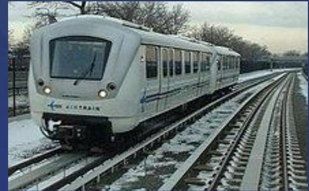
**Les trains ART de Bombardier se déplacent grâce à la bande d'aluminium que l'on voit entre les voies**
