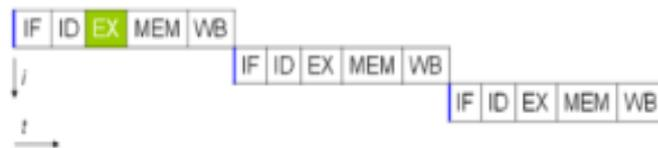
Séquençage des instructions dans un processeur sans pipeline. Il faut 15 cycles pour exécuter 3 instructions.
