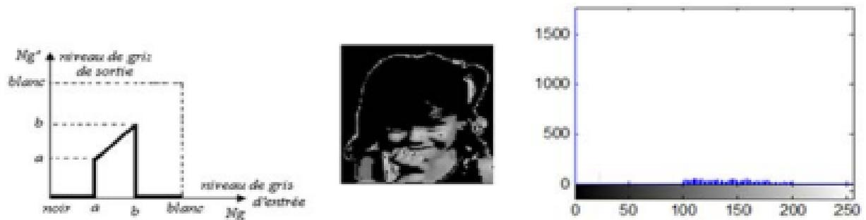
Figure 3.13. Seuillage avec fenêtre d'intensité entre 100 et 200
